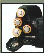
Le SX1 peut être alimenté par des piles alcalines ou des accus AA.
