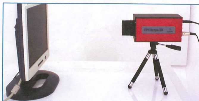
La fluidité d'affichage est évaluée en plaçant la sonde optique de l'Optiscope-SA, d'Eldim, en face de chaque écran.
