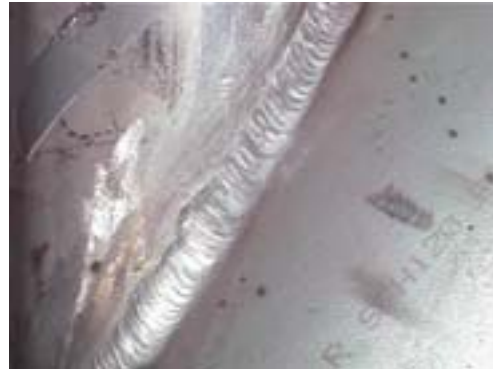
Détail de la zone soudée après traitement chimique de surface : le but de ce traitement n'est pas de supprimer le joint de soudure lui-même, mais la coloration qui l'accompagne.
