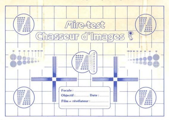
Cette mire doit être utilisée à une distance égale à 50 fois la focale de l'objectif testé ; ceci correspond, en 24 x 36, à un champ de 120 x 180, au centre duquel devra être placée notre mire. Pour des mesures plus précises (notamment contrôle de définition sur les bords) il est souhaitable d'adopter l'une des solutions suivantes :
