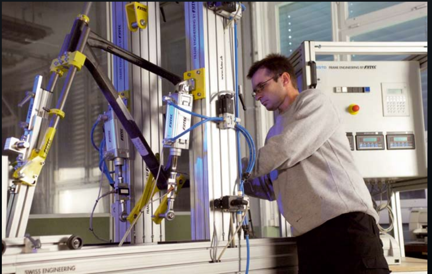
Team elite te01 en test de vibration
