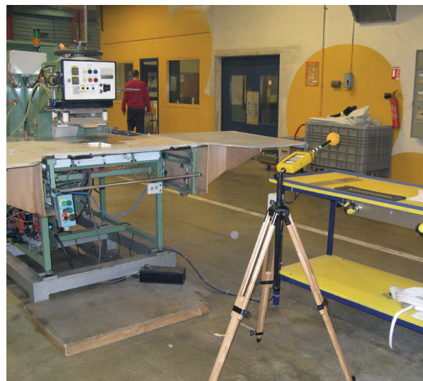
Figure 5. Mesure de champs sur presse HF
